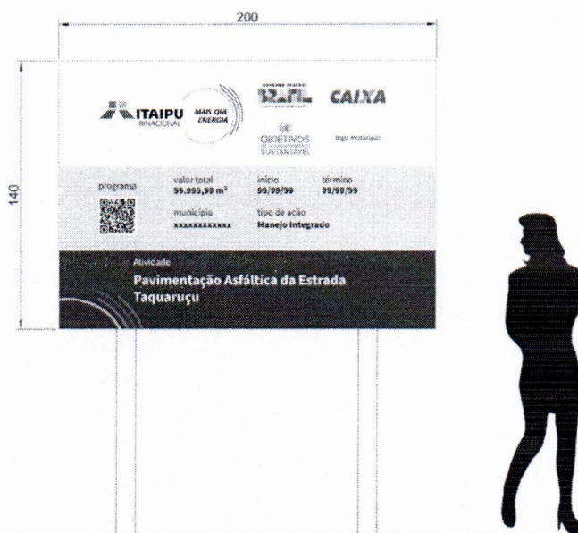
PLACA DE OBRA - PROPOSTA 1,4x 2,0m ESCALA 1/50
